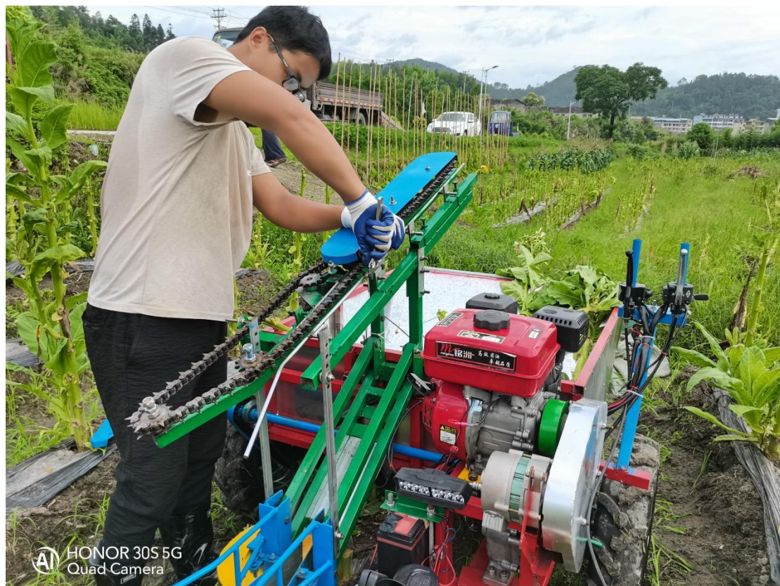
图 22 三明市农业学校教师周国辉与入田试验中的第 1 代小型烟秆收获机
